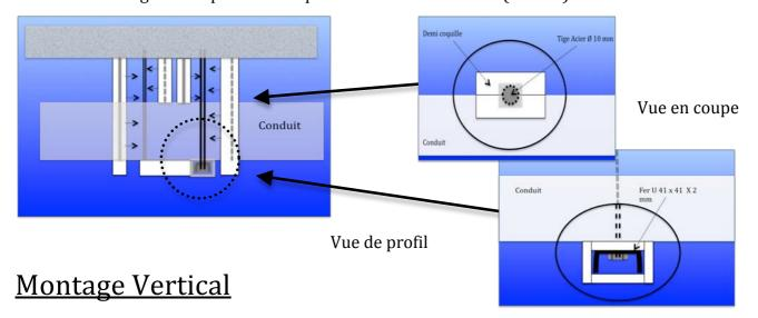
Montage par caissons auto portant avec reprise de charge tout les 5 mètres. Traversée des planchers en continue avec manchette en 25 mm, avec reprise de charge par un talon de 150 mm en appuie sur le plancher, un joint coupe feu comble l'espace entre le plancher et le conduit.
